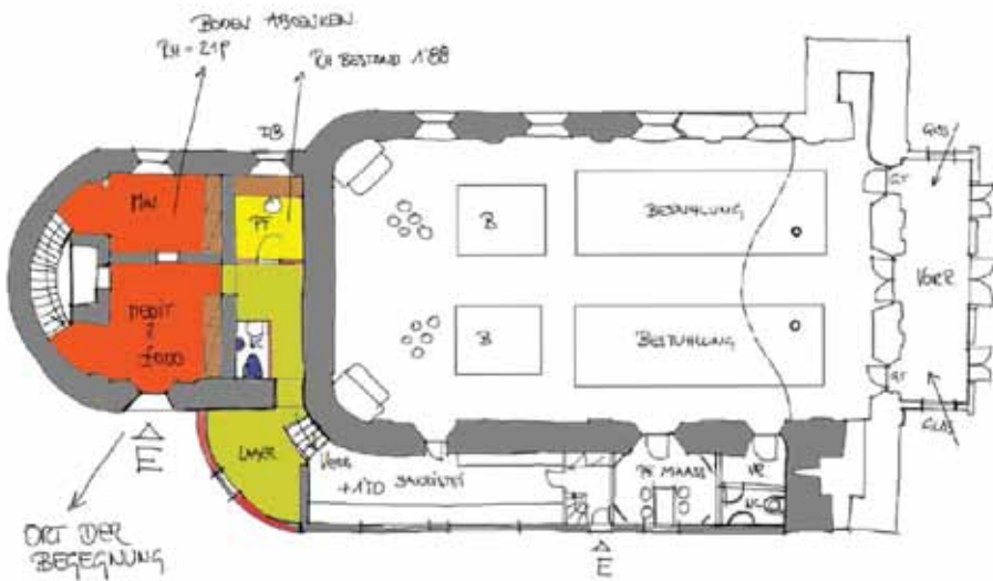
Ausbau der Kellerräume und Erweiterung der Sakristei. (Planung: Gigele Bau GmbH)
